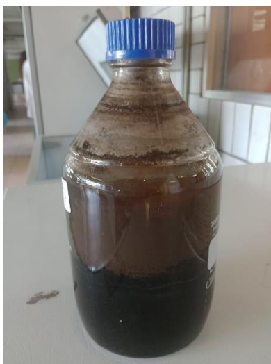
Figura 5. Reactor implementado para la adaptación de los lodos anaerobios con lirio acuático como fuente de alimentación.
