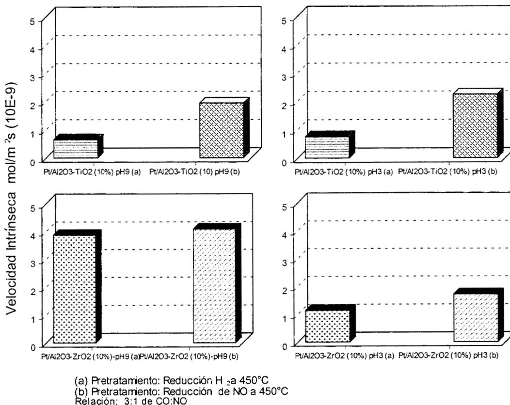
**Figura 6.6** Resultados de la velocidad intrínseca de los catalizadores de los catalizadores Pt/Al<sub>2</sub>O<sub>3</sub>-TiO<sub>2</sub> 10% (pH 3 y 9) y Pt/Al<sub>2</sub>O<sub>3</sub>-ZrO<sub>2</sub> 10% (pH 3 y 9).
