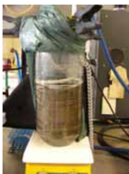
Fig. 5.1. Reactor agitado que contiene al consorcio microbiano degradador de MTBE.
