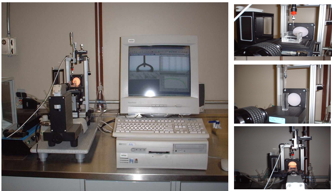
Figura 15. Goniómetro Kruss G10 DSA. En la imagen principal se muestra el equipo completo incluyendo la bomba de inyección adaptada. En el recuadro superior se presenta al equipo en condiciones de evaluación de \theta en sistemas sólido/líquido/líquido. En el recuadro medio se presenta al equipo bajo condiciones de evaluación de \gamma_i de sistemas líquido/líquido. El recuadro inferior muestra la alineación que debe existir entre el sistema de video, la muestra y el haz de luz de la lámpara. Para la determinación de \gamma_i inicialmente se coloca la fase menos densa en la celda de cuarzo, esta celda es colocada en la cámara ambiental (previamente ensamblada a la plataforma porta muestras y ajustada a la temperatura de prueba) y se realiza un barrido de la imagen de la celda con el líquido para establecer condiciones óptimas de contraste, foco e iluminación. Posteriormente se coloca la punta de la aguja en la zona de barrido y se forma lentamente una gota de la fase más densa hasta lograr un volumen óptimo ( i.e. justo antes de soltarse de la aguja). En este instante se toma una imagen de la gota y por ajuste a la ecuación de Young-Laplace para superficies curvas se obtiene el valor de \gamma_i . Debido a que la determinación de \theta es más laboriosa la explicación de la técnica se presenta en la parte de procedimientos.
