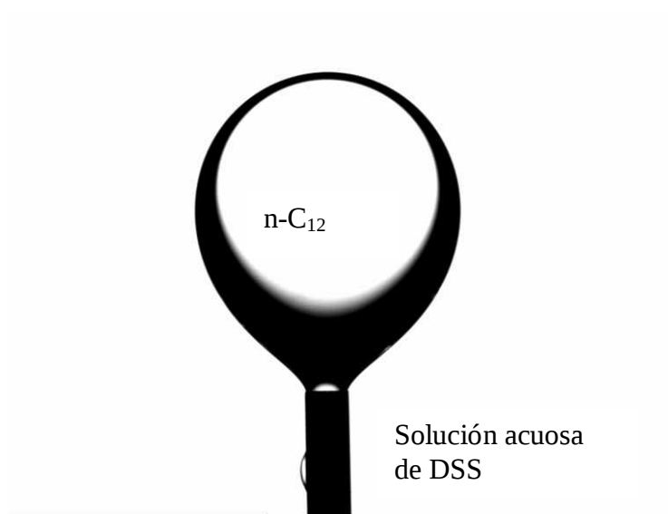
Figura 37. Imagen típica de la gota de n -C 12 inmersa en la solución acuosa de DSS a 25°C. La toma correcta de la imagen se realiza cuando se forma el máximo menisco entre la punta de la aguja y la gota (justo cuando va a desprenderse).
