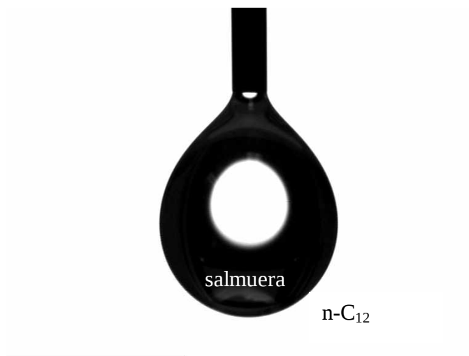
Figura 41. Imagen típica de una gota de salmuera+DSS suspendida en el n\text{-C}_{12} a 25^{\circ}\text{C} . En este caso la interfase es de tipo agua/aceite.
