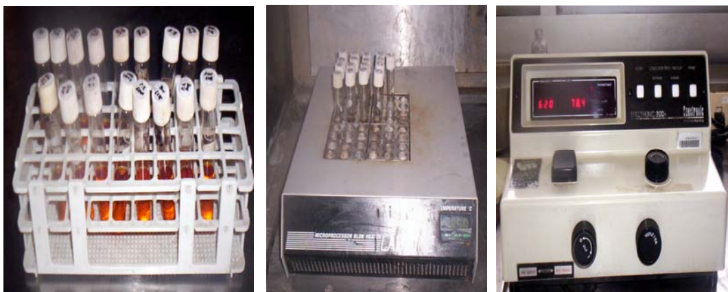
Fig. 22 Preparación de estándares, digestión para DQO y lectura en el espectrofotómetro
