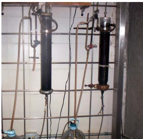
Fig. 12 Reactores biológicos, el de lado derecho es de tipo UASB y el de lado izquierdo es de película fija.
