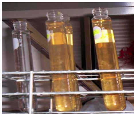
Fig. 19 Preparación de estándares para amonio y mediciones en el espectrofotómetro
