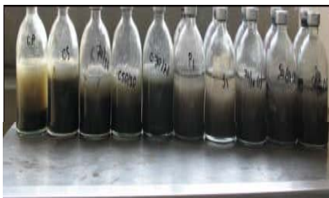
Figura 4.2. Diseño de las botellas serológicas para la cinéticas
