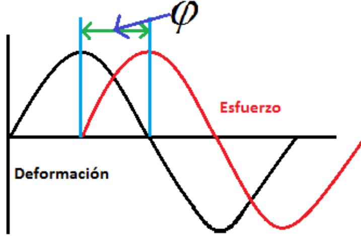
Figura 12 Material viscoelástico: esfuerzo, deformación y desfase entre ambos.
