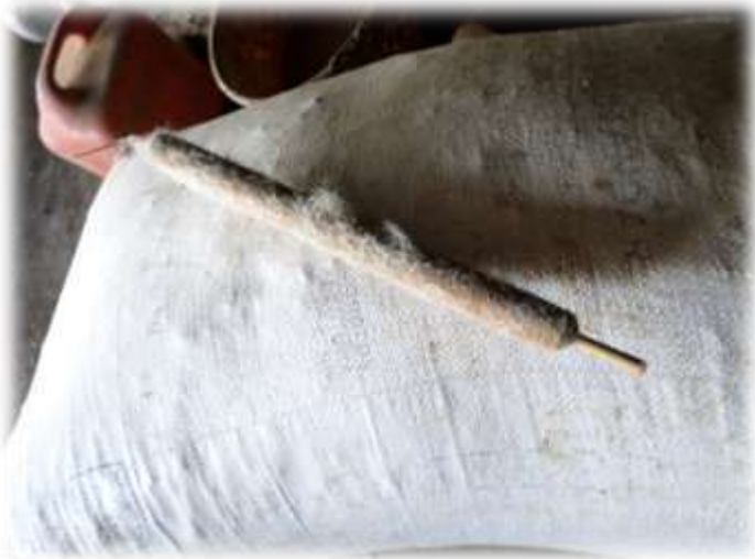
Imagen 14. Vara de la planta del tule de donde se extrae la plumilla (se observa como pelusa) que sirve de “amarre” para el lodo de barro, evitando que salga la humedad rápidamente y la pieza se rompa o cuartee.
