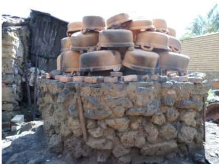
Imagen 22. Horno de cazuelas de la familia Allende en el taller de “los pichones”. Las cazuelas se acomodan de manera horizontal boca abajo para lograr que el fuego toque todas las piezas y la temperatura se distribuya mejor. Las piezas de hasta arriba son para tapar, ya no sirven.
