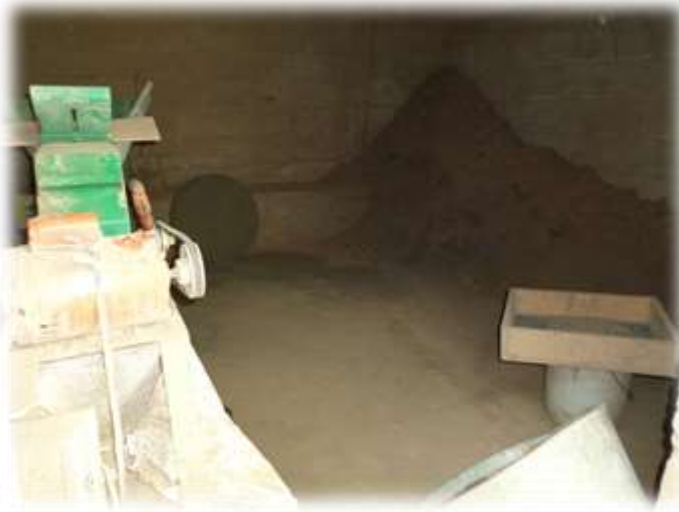
Imagen 16. Al fondo la tierra de barro almacenada y protegida de la humedad. El molino de la familia Santamaría Nopaltitla y la malla de alambre para cernir la tierra de barro.
