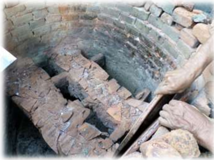
Imagen 23. Los comales se acomodan de manera vertical, separando cada uno únicamente con una pequeña piedra. A manera de que a todas les toque fuego y la temperatura este bien distribuida por todo el horno.
