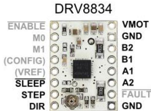
*Nota. Adaptado de DRV8834 Low-Voltage Stepper Motor Driver Carrier, por Pololu, Rootirc & Electronics, (2015).*
