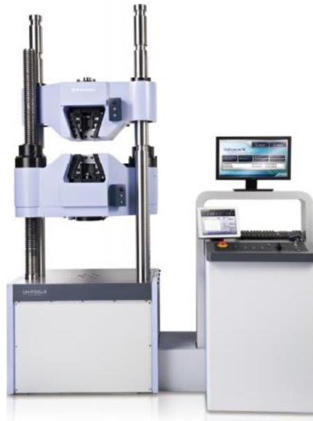
*Nota. Adaptado de Hydraulic Universal Testing Machines, por Shimadzu (2021).*
