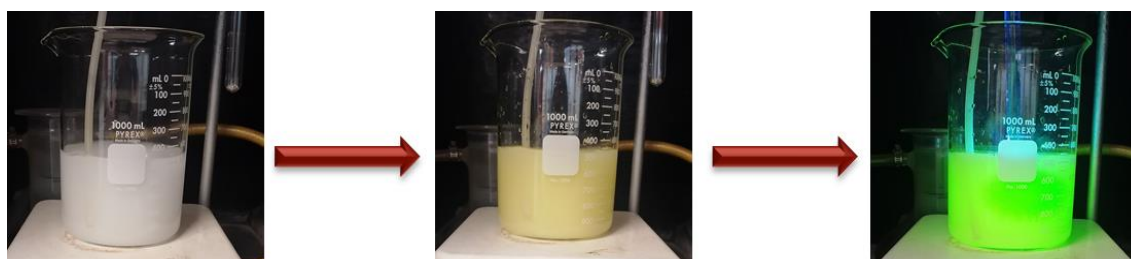
Figura 2.5. Síntesis de los fotocatalizadores por el método de fotodepósito
