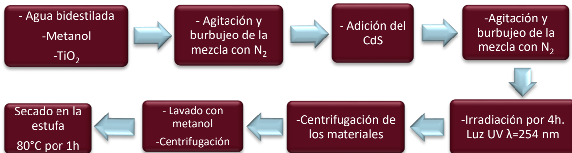
Figura 2.6. Diagrama de flujo de la síntesis por el método de fotodepósito.
