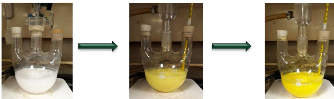
Figura 2.3. Síntesis de los fotocatalizadores por el método de impregnación.
