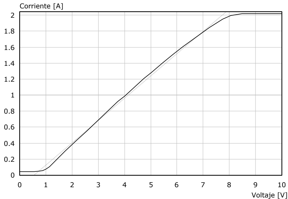
Figura 4.11. Respuesta del sistema actuador del control. La línea punteada indica la curva de ajuste para la parte lineal entre 1 y 8 V.
