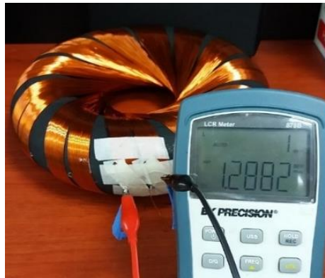
Figura 17. Inductancia de la bobina de Rodin. La inductancia obtenida fue de 1.28 mH (mili Henrios) donde los hilos fueron conectados en paralelo.
