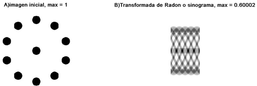
Figura 3.2: En la imagen A) observamos la imagen inicial y en la imagen B) podemos observar el sinograma de la imagen A) que no es otra cosa que la representación gráfica de la transformada de Radon.
