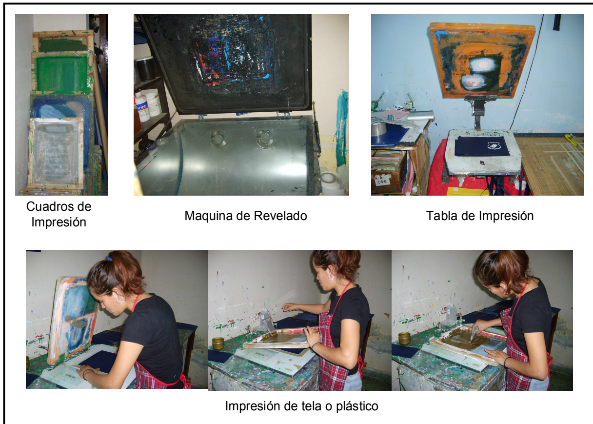
Figura 5.5 Cuadros de Impresión, Máquina de Revelado, Tabla de Impresión e Impresión de tela o plástico.
