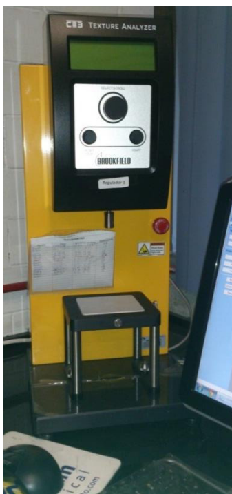
Figura 5. Brookfield Texture Analyzer C3 empleado para realizar la prueba de compresión de frutos
