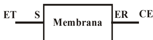
Figura 15. Configuración con cuatro terminales usando el potencióstato 283 de PAR, los dos electrodos de referencia, S (sensor) y ER (electrodo de referencia en la configuración de tres electrodos), quedan colocados a ambos lados de la membrana y muy cerca de ella; mientras que los electrodos entre los cuales se varía el potencial, ET (electrodo de trabajo en la configuración tradicional con tres electrodos) y CE (contraelectrodo), son colocados en ambos extremos de la celda con membrana. Figura tomada de la referencia [50].
