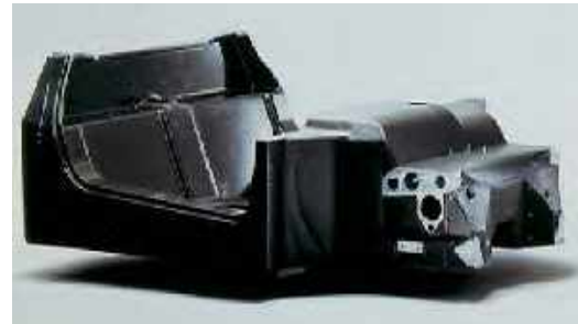
Gráfico 51 Chasis monocasco fibra de carbono automóvil de calle Ferrari F40 (1990)
