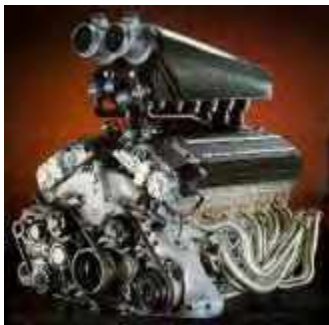
Gráfico 45 Motor BMW de automóvil de calle McLaren f1 (1995)
