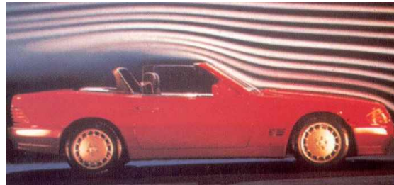
Gráfico 52 Automóvil de calle Mercedes-Benz 500 SL (1989) en el túnel de viento
