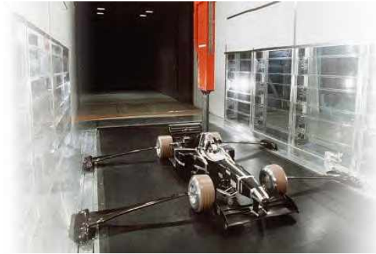
Gráfico 36 Túnel de viento parte interior probando el Lotus 78
