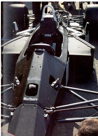
Gráfico 47 Chasis monocasco de fibra de carbono Lotus 93T Fórmula 1 (1982) Tipo panal de abeja
