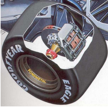
Gráfico 40 Frenos de disco de carbono de Fórmula 1 Brabham BT45 (1976)
