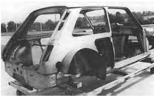
Gráfico 37 Chasis monocasco Renault R5 turbo (1978)
