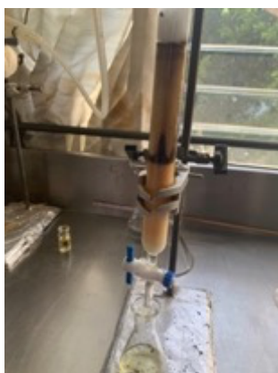
Figura 10. Cromatografía en columna abierta del fraccionamiento del extracto del CTM.
