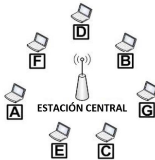
Figura 3.1. Ejemplo de una red inalámbrica
