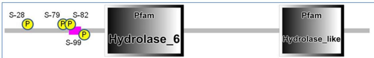
**Figura 21.** Esquema de la proteína Pc22g04840 en la cual se aprecian los dominios hidrolasa y los cuatro sitios de fosforilación que fueron identificados por LC-MS/MS.
