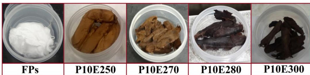
Figura 3.5 Fotografía digital del color de nanofibras de PAN y nanofibras de PAN estabilizadas a 250, 270, 280 y 300 °C.
