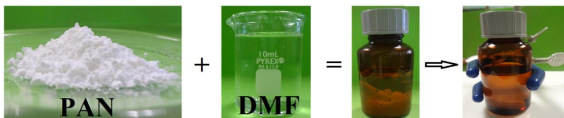
Figura 2.1 Preparación de una solución al 10 % en masa de PAN 5 .
