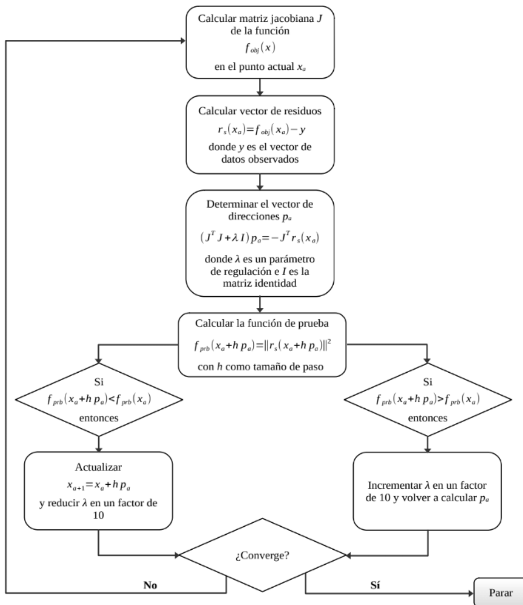
Figura 5.3-1. Diagrama del algoritmo Levenberg-Marquardt (Press et al., 2007).
