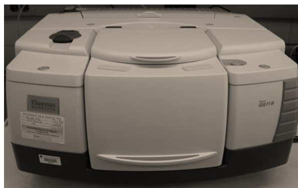
Figura 14. Espectrofotómetro Nicolet iS50 FT-IR.
