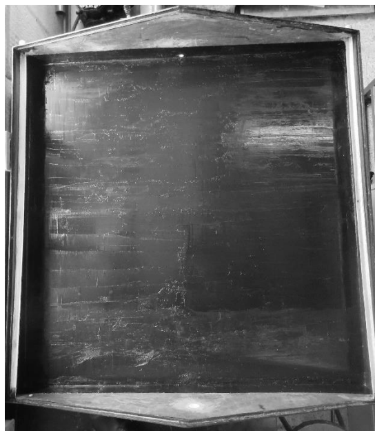
Figura 28. Base del destilador con la película absorbedora.
