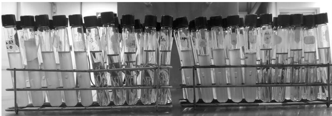
Figura 44. Muestras preparadas en lactosa, del agua de entrada y salida para el agua de grifo y agua simulada de mar después de 24 horas.
