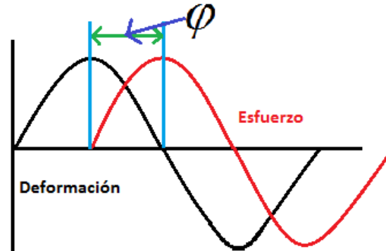
Figura 19. Material Viscoelástico: esfuerzo, deformación y desfase entre ambos.
