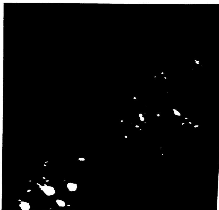
Fig. 9.10 Imágenes de microscopía electrónica de transmisión (TEM) obtenidas con el catalizador de 1%Pt-1.6%Sn reducidas a 800°C. (a) campo claro y (b) campo oscuro.
