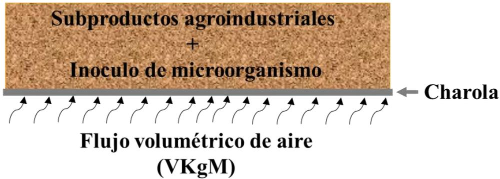
Figura. 1.1. Esquematación de un biorreactor de charolas.
