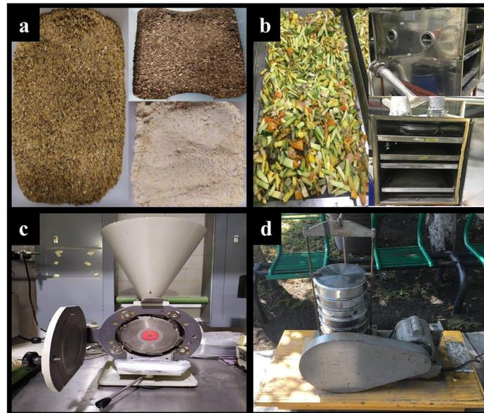
**Figura 3.3.** Preparación del sustrato agroindustrial; a) subproductos orgánicos, mezcla de subproductos de frutas y verduras con pasta de soya; b) proceso de secado; c) disminución del tamaño de partícula mediante molienda; d) tamizado.
