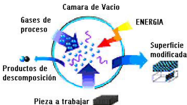
Figura 12. Esquema del proceso de polimerización por plasma.
