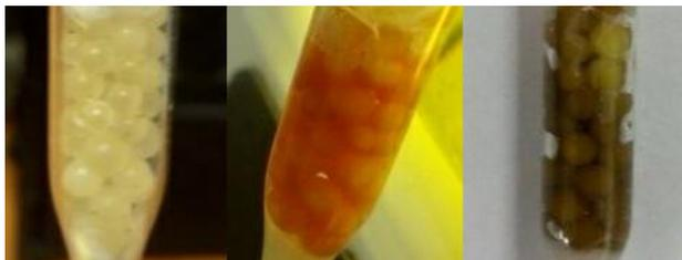
Figura 37. Cambio de coloración de la resina a pH 2: a) antes del contacto con Cr(VI), b) durante el contacto y c) posterior del contacto.
