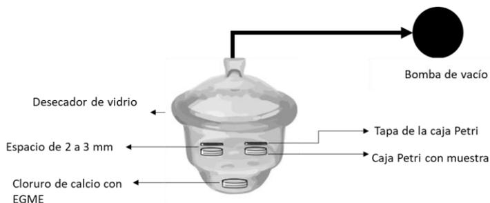
Figura 19.- Sistema para la determinación del área superficial específica (ASS) por el método de adsorción del líquido polar etilen glicol monoetil éter (EGME).
