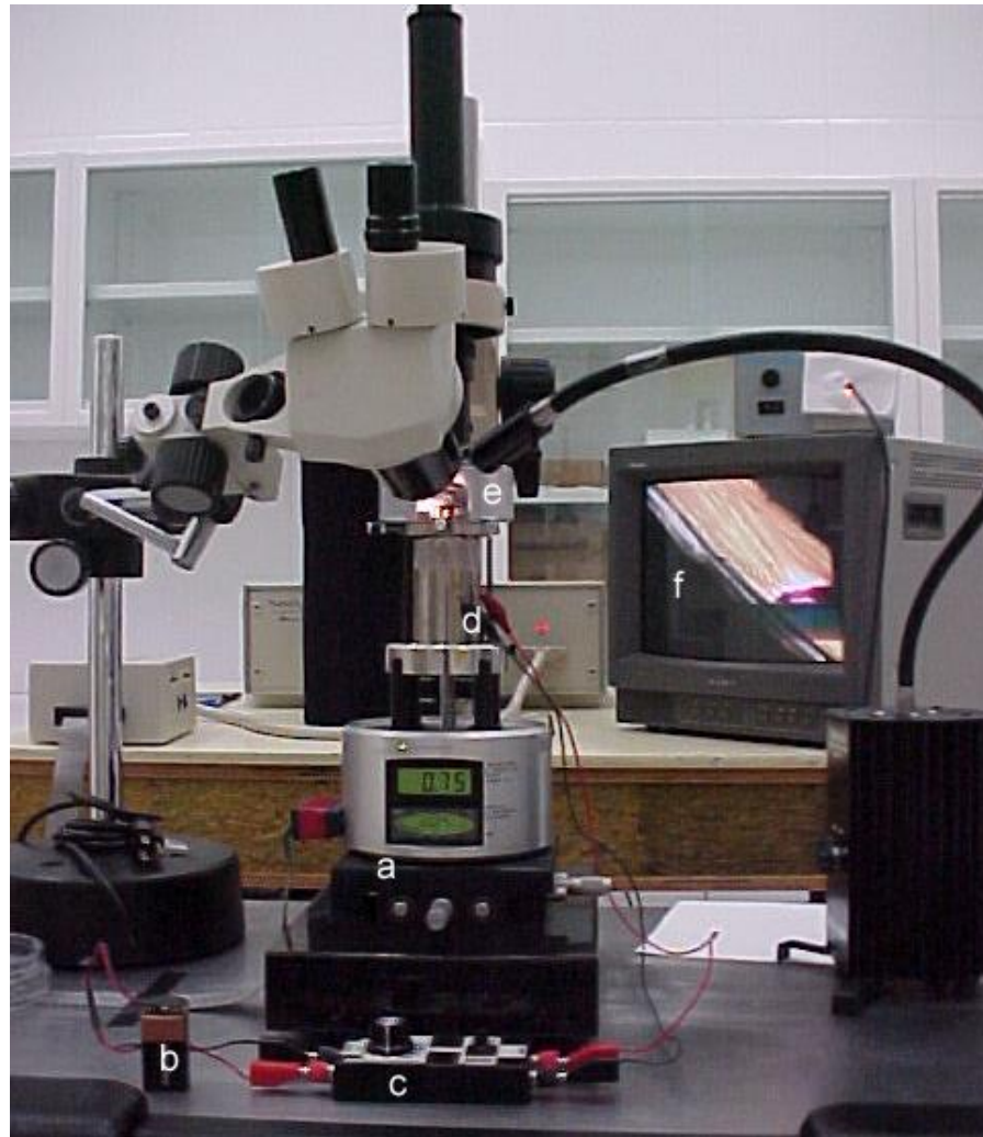
Figura 10. Montaje del microelectrodo con el circuito externo en el AFM. Se observa: a) El AFM, b) pila o fuente de poder, c) circuito externo, d) conexión del circuito externo al microelectrodo, e) cabeza del AFM, donde se colocó el microelectrodo para ser visualizado, f) proyección de la imagen del microelectrodo, ésta ayudó a posicionar la punta en el área de interés a analizar.
