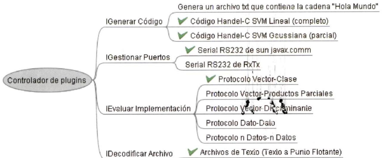
Figura 4.5 – Muestra los 4 puntos de extensibilidad y todos los plugins que las extienden. Los plugins marcados fueron los que se incluyeron en la versión liberada del gCodeGen. Los que no están marcados sirvieron para la evaluación de la SVM plantilla.
