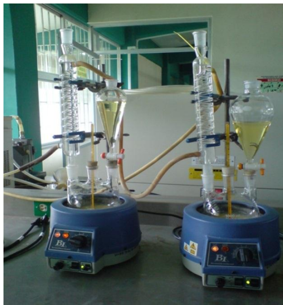
Figura 5. Sistema para la preparación de los soportes de \text{TiO}_2 y \text{TiO}_2\text{Ce}
