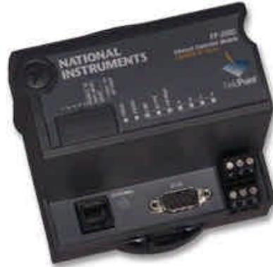
El FP-100 de National Instrument es un modulo de red para el sistema de entrada/salida Field Point (FP). El modulo de red se conecta a un nodo de hasta nueve módulos de entrada/salida a una red RS-232. Una red consiste de hasta 25 nodos de red para un total de 225 módulos de entrada/salida.
