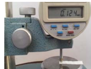
Figura 59. Grosor medido con medidor de espesor de la marca MITUTOYO.
