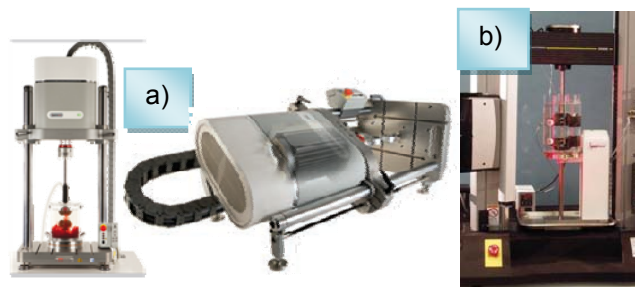
Figura 23. a) Máquina de pruebas mecánicas horizontales y verticales ElectroPuls E3000 de INSTRON. b) Máquina de pruebas mecánicas BioPuls de INSTRON.
