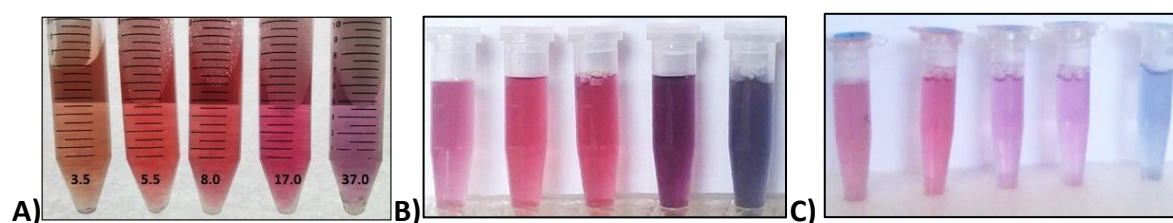
Figura 28. A) Soluciones de AuNP originales, B) Soluciones de AuNP-Oligo(A)-ssDNA, C) Soluciones de AuNP-Oligo(A)-ssDNA después de desnaturalizar.
