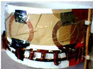
Fig. 4.2 Antena PERES de 8 cavidades convertida en antena de volumen
