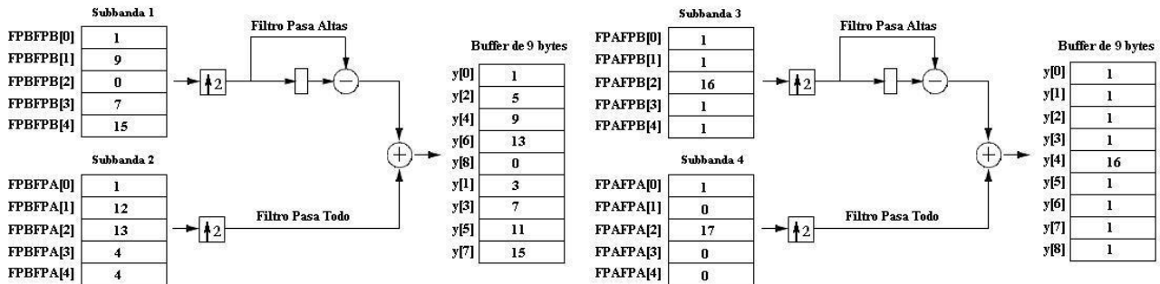
Figura 4.42: Resultado de la primera etapa de síntesis. En las entradas se reciben las cuatro subbandas de 5 bytes cada una. A la salida se obtienen dos arreglos de 9 bytes, que a su vez servirán de entrada para la siguiente etapa de síntesis.
