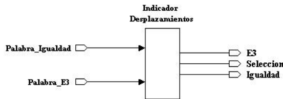
Figura 4.59: Componente Indicador de Desplazamiento , es un componente descrito combinatorialmente, basado en una tabla de verdad. Con la ayuda de dos vectores de entrada llamados: Palabra_ Igualdad y Palabra_ E3, genera tres salidas llamadas: E3, Igualdad y Selección, de las cuales las dos primeras pasaran a la segunda parte secuencial. La salida Selección indica cuantos desplazamientos a la izquierda de los limites se deben realizar.
