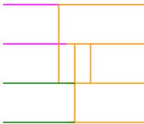
*Fig. 4.4. Lógica básica para unir dos sublistas ordenadas de dos elementos en el método de intercalación por intercambio (cada línea vertical implica una comparación e intercambio si es necesario).*
