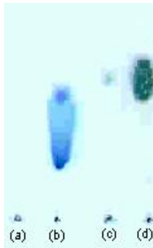
Figura 10. Cromatografía en capa fina de la reacción del índigo con el ABTS^{1+} . La mancha "a" corresponde a la lacasa, mancha "b" al índigo, mancha "c" a la reacción de ABTS^{1+} + índigo y la mancha "d" corresponde al ABTS^{1+} .
