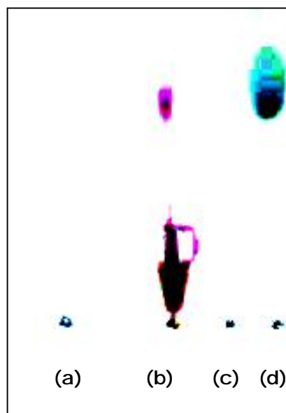
Figura 28. Cromatografía en capa fina del p -cresol con el ABTS^{*+} , (a) corresponde a la lacasa, la mancha (b) corresponde a la mezcla de p -cresol + ABTS^{*+} , la mancha (c) es la mezcla de ABTS reducido + Sudán II y la mancha (d) es solución de ABTS/ABTS^{*+} .
