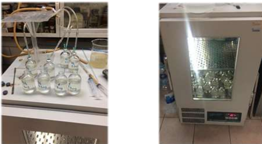
Figura 8. Adición de oxígeno a botellas serológicas y posterior incubación.
