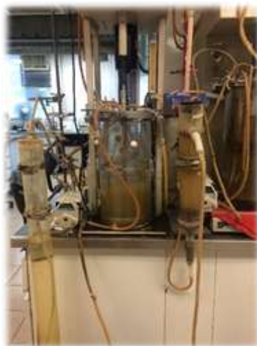
Figura 7. Reactor en continuo con biomasa nitrificante.
