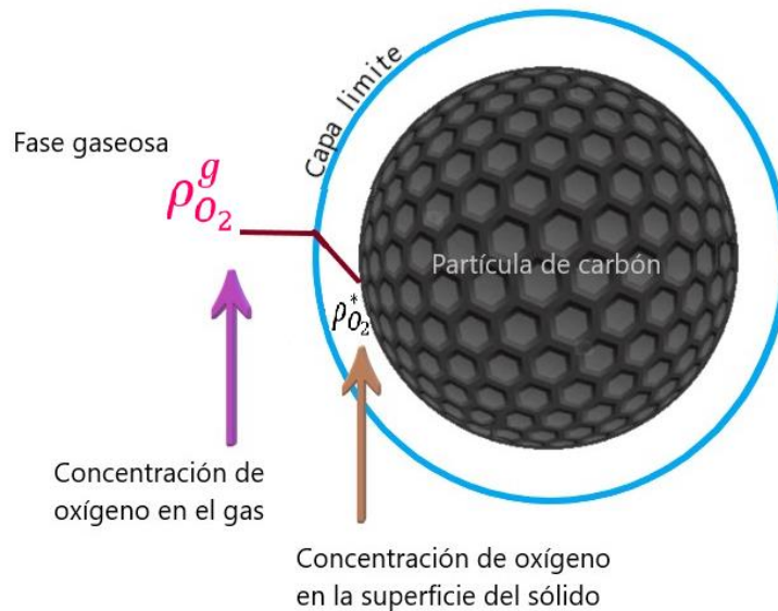
Figura E2 Representación de la difusión de oxígeno desde el seno del gas hacia la superficie de la partícula sólida de carbón, así como los perfiles de concentración másica alrededor de la capa límite cuando la resistencia de masa externa es la fase controlante.
