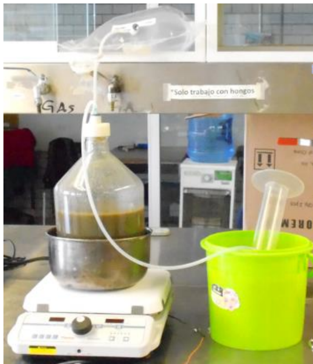
Figura 5.3. Fermentación oscura en reactor de 5 L.
