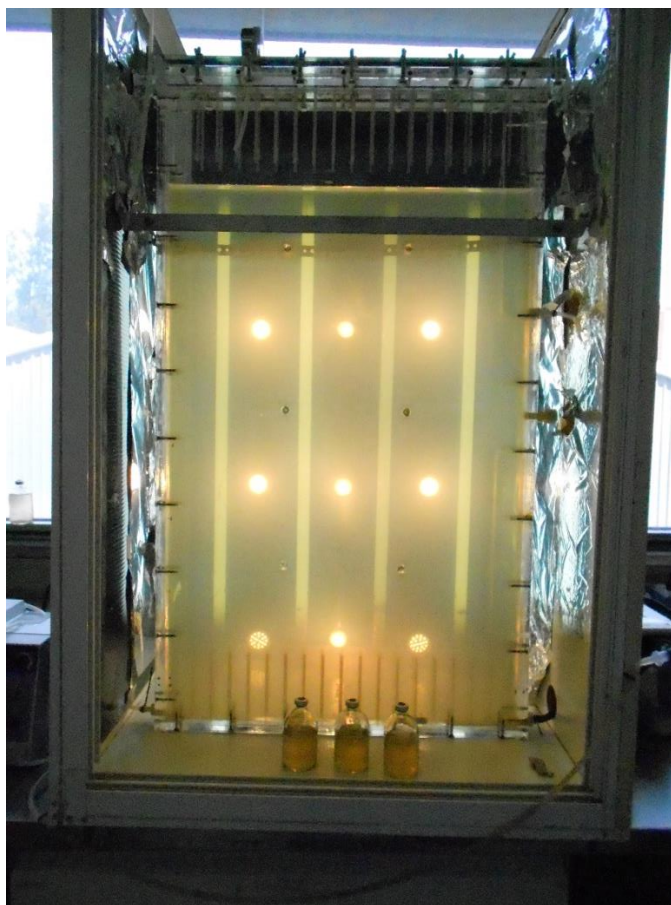
Figura 6.4. Arreglo de lámparas para el sistema de iluminación del fotobiorreactor.
