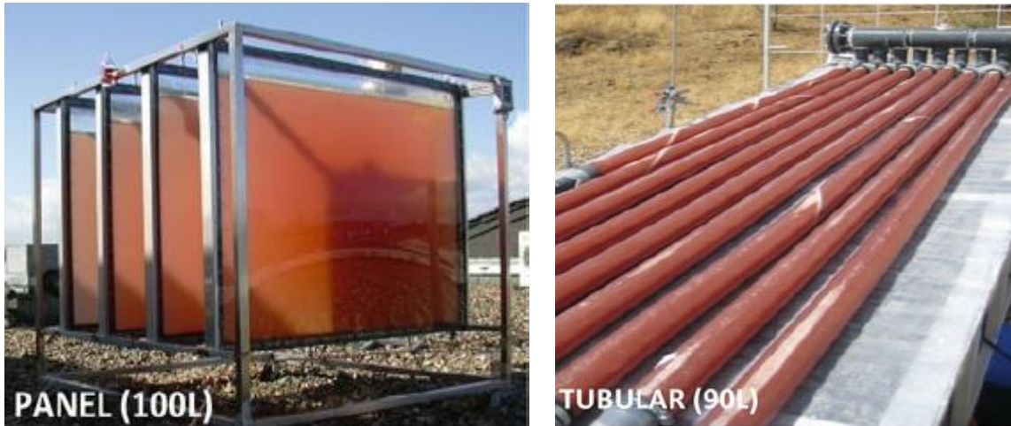
Figura 6.2. Reactor plano de 100L y reactor tubular de 90 L utilizado por Gebicki et al. (2010) y Boran et al. (2012) para la producción de H 2 .
