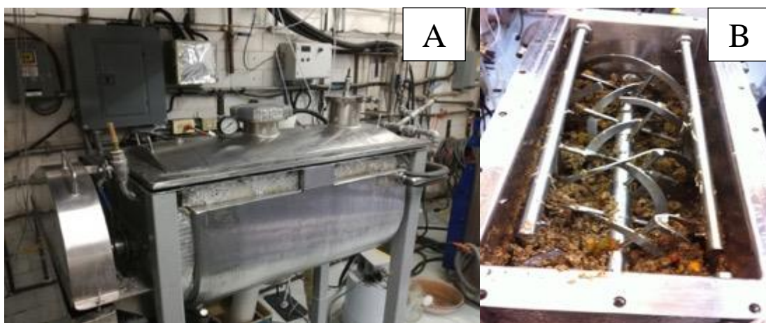
Figura 6.3. Biorreactor escala piloto (LH) para la fermentación en cultivo en medio sólido. A) Vista lateral del biorreactor y B) Vista superior del biorreactor.
