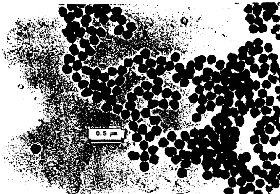
fot. 2.d Partículas de PAN, preparadas por iniciación térmica en medio acuoso, en presencia de n-PrOH.
