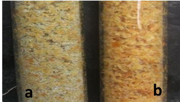
Figura 13. BRTV empacados con aserrín utilizado como soporte, inoculado con *T. harzianum* PBLA después de 50 h de cultivo. a) 0.42g/L, b) 21g/L.
