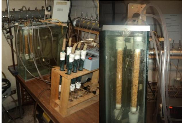
Figura 1. Biorreactores tubulares verticales empacados con aserrín inoculado con *T. harzianum* PBLA incubados en un baño con agua a 30°C.
