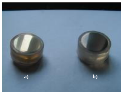
Figura 2.2 Electrodos sólidos de: a) cristal de calcopirita (ES-CP); b) concentrado de calcopirita (ES-CC)
