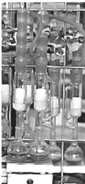
Figura 4.2. Equipo utilizado en la extracción de los hidrocarburos totales de petróleo (HTP).
