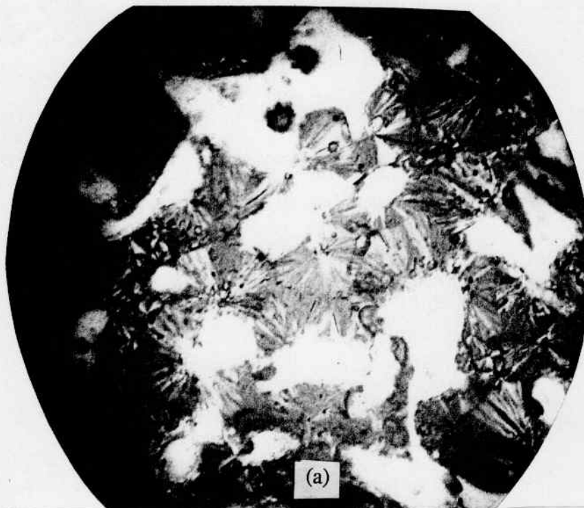
Fig. 14. Fotomicrografías polarizadas de las mezclas PCL-DAC: Mezcla 75/25, tal como se obtuvo después de evaporar el solvente (a) y después de ser tratada térmicamente (b); mezcla de 25/75 PCL-DAC después de evaporar el solvente.
