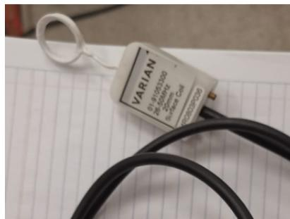
Figura 2.39: Imagen de una antena para ojo de un equipo VARIAN.
