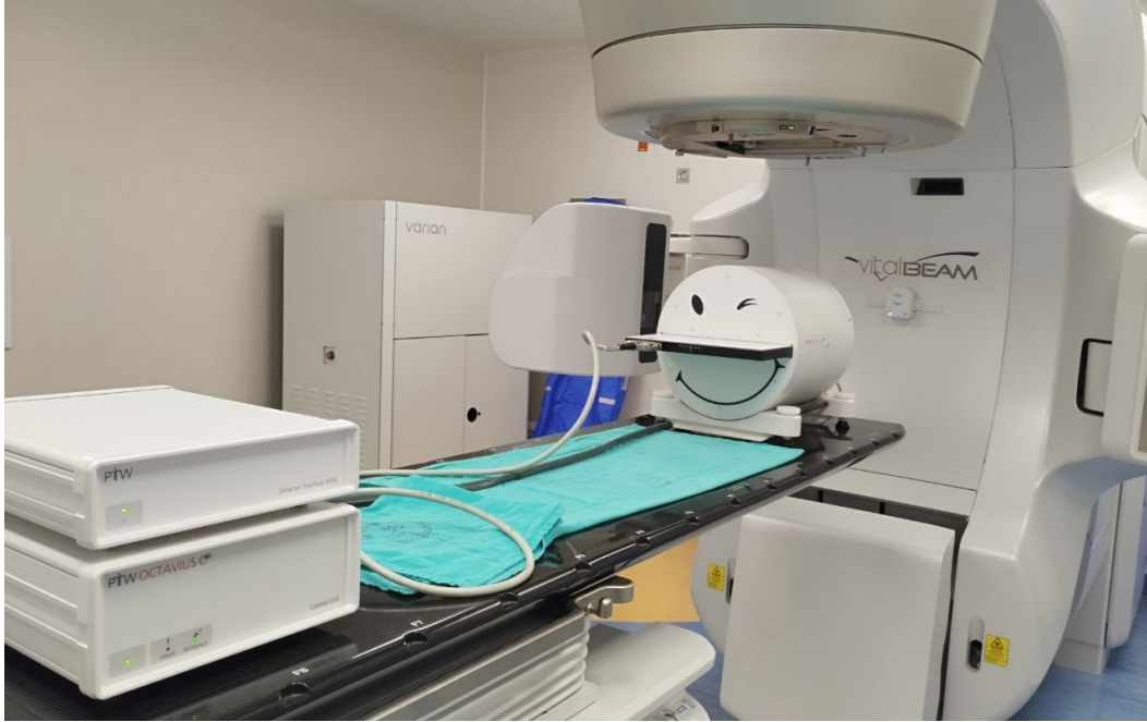
Figura 24. Sistema Octavius con todos sus elementos. De izquierda a derecha el electrómetro sobre la unidad de control conectada con cables a la unidad de rotación y el detector, el maniquí tiene colocado el top estándar. Pegado al gantry se aprecia el inclinómetro.
