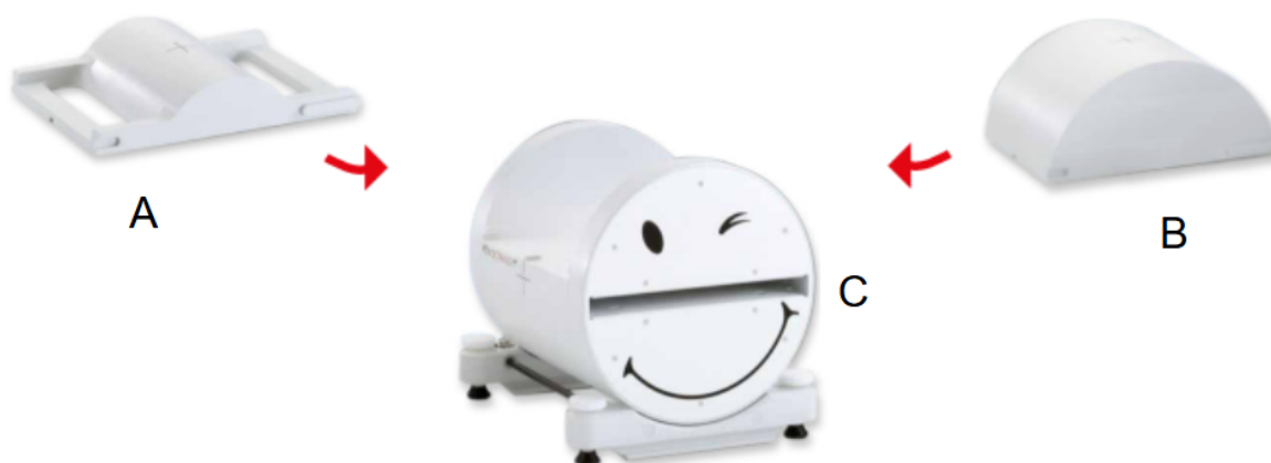
Figura 22. A) top SRS, B) top estándar, C) unidad de rotación del maniquí Octavius con ranura para insertar un arreglo de detectores.
