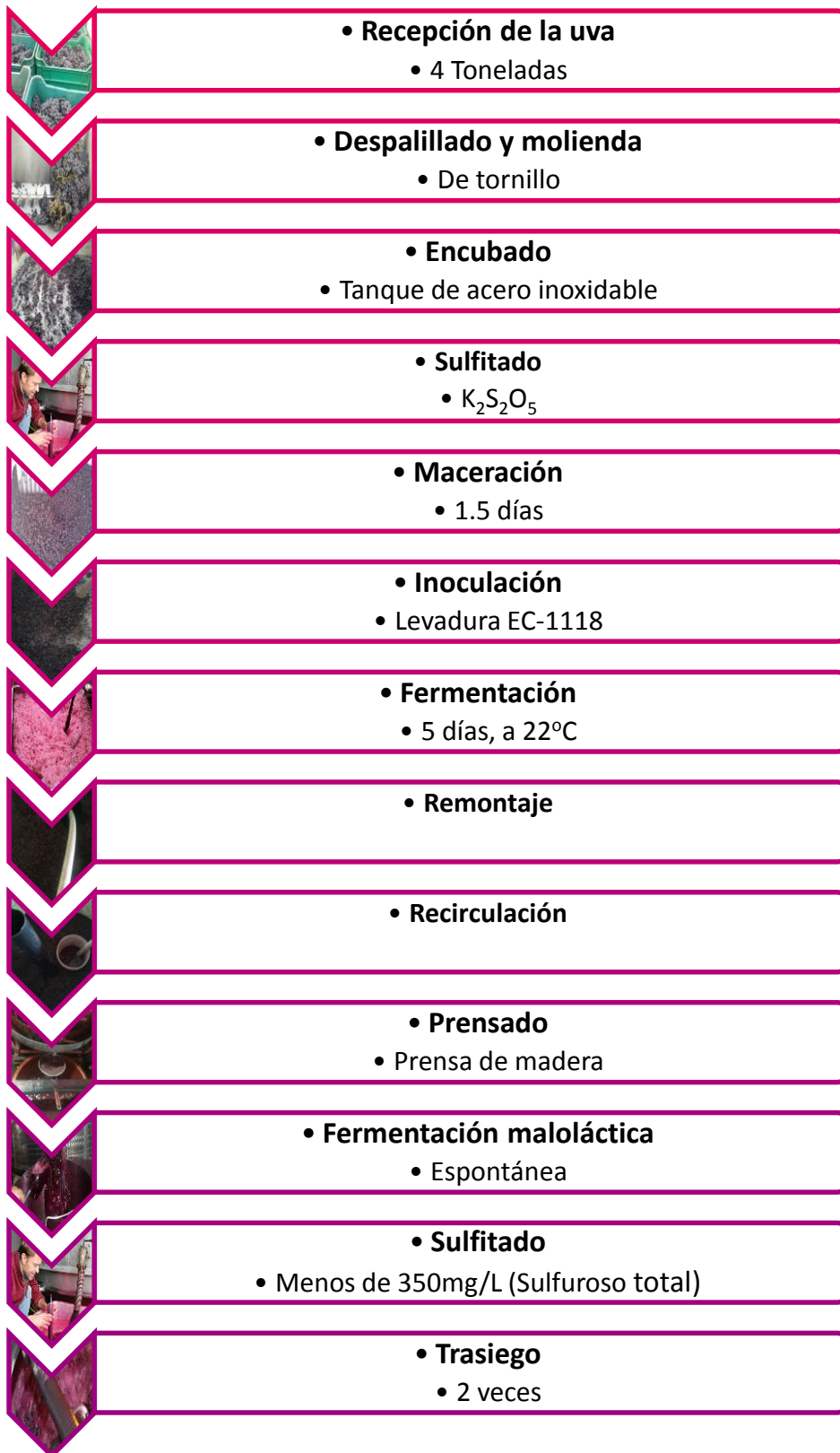
Figura 5.2. Diagrama del proceso de vinificación.
